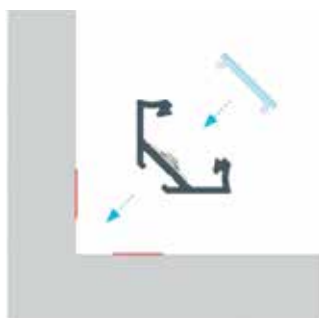
Montageanleitung für das Eckprofil C mit Abdeckung BASIC und doppelseitigem Klebeband
