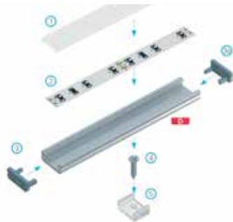
Explosionszeichnung zum Beleuchtungssystem bestehend aus folgenden Elementen: Profil C und (1) Abdeckung BASIC, (2) LED-Streifen, (3) Endkappe mit Öffnung, (3a) Endkappe ohne Öffnung, (4) Montageschraube, (5) MINI-Montageklammer D
