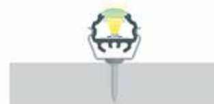
Fertiges Resultat nach der Montage des Rundprofils MICO mit Abdeckung SLIM LENS 15 und Metallmontageklammer MICO
