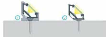
Fertiges Resultat nach der Montage des Eckprofils C mit (1) Kunststoffmontageklammer CH, (2) Metallmontageklammer CH
