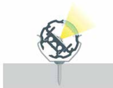
Anwendungsbeispiel für die Änderung der Lage des Profils COSMO um -45° Winkel mit Metallmontageklammer COSMO
