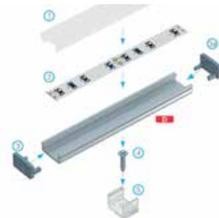
Explosionszeichnung zum Beleuchtungssystem bestehend aus folgenden Elementen: Profil C und (1) Abdeckung HIGH, (2) LED-Streifen, (3) Endkappe mit Öffnung, (3a) Endkappe ohne Öffnung, (4) Montageschraube, (5) Montageklammer D HIGH
