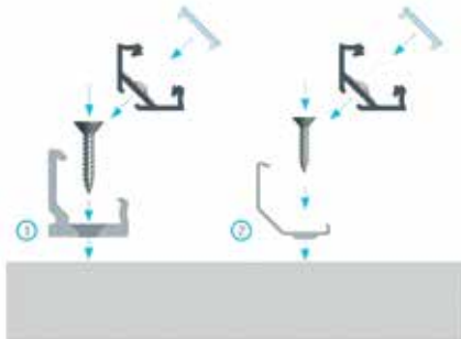
Montageanleitung für das Eckprofil C mit Abdeckung BASIC mit (1) Kunststoffmontageklammer CH, (2) Metallmontageklammer CH
