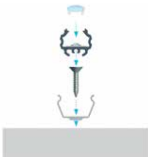
Montageanleitung für das Rundprofil MICO mit Abdeckung SLIM LENS 15 und Metallmontageklammer MICO
