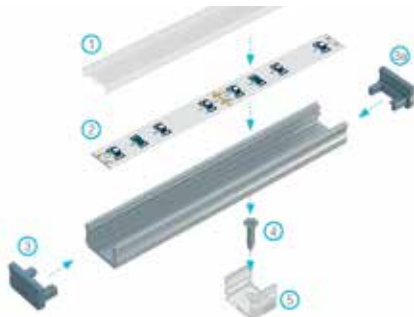
Explosionszeichnung zum Beleuchtungssystem bestehend aus folgenden Elementen: Profil A und (1) Abdeckung BASIC, (2) LED-Streifen, (3) Endkappe mit Öffnung, (3a) Endkappe ohne Öffnung, (4) Montageschraube, (5) MINI-Montageklammer A
