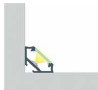
Fertiges Resultat nach der Montage des Eckprofils C mit Abdeckung BASIC und doppelseitigem Klebeband
